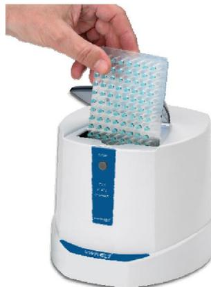
**Korrektes Einsetzen einer PCR-Platte**
